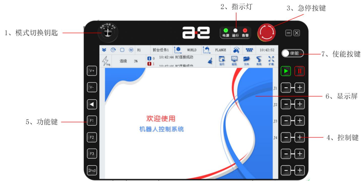
图 2-1 示教器组成部件示意图
